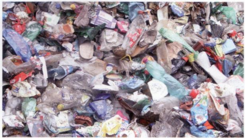
Recyclingmaterial aus der Aufbereitungsanlage in Žilina aus dem ballistischen Separator (rollende Fraktion)
